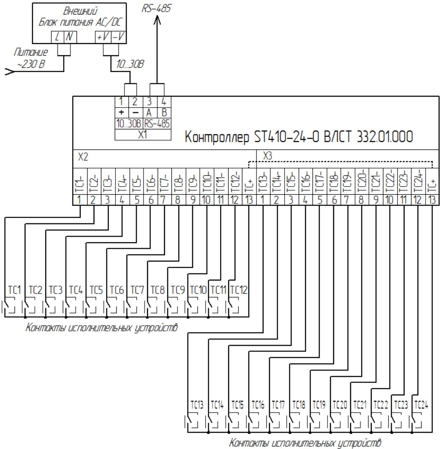
Рисунок В.1 – Пример подключения контроллера
